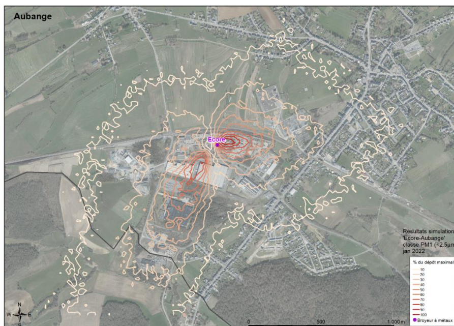
Figure 4: Exemple de panache de dispersion d'émissions canalisées – Site d'Ecore à Aubange
